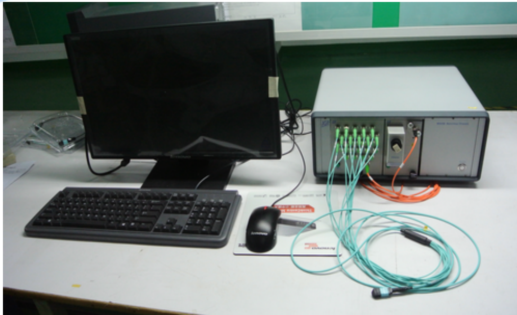
IL/RL Test Meter
