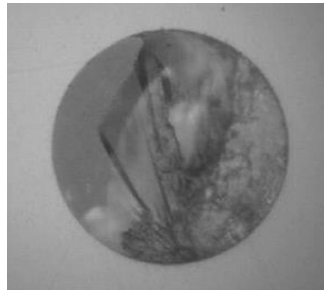
研磨前 損傷の大きいファイバの端面
