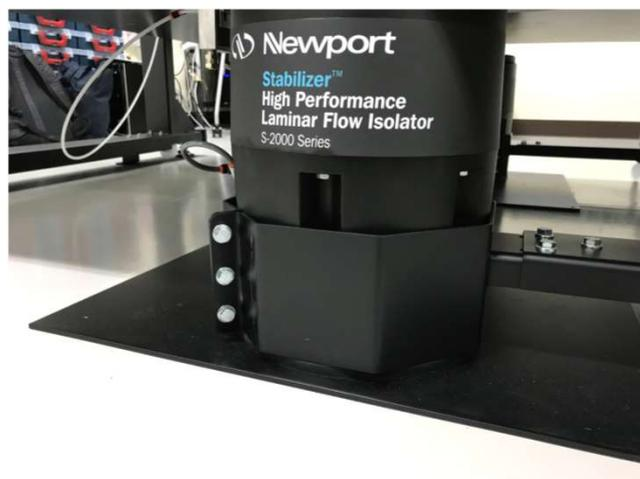
\*簡単な採寸後に製作する為、どのようなサイズの除振台にも取り付ける事ができます。
